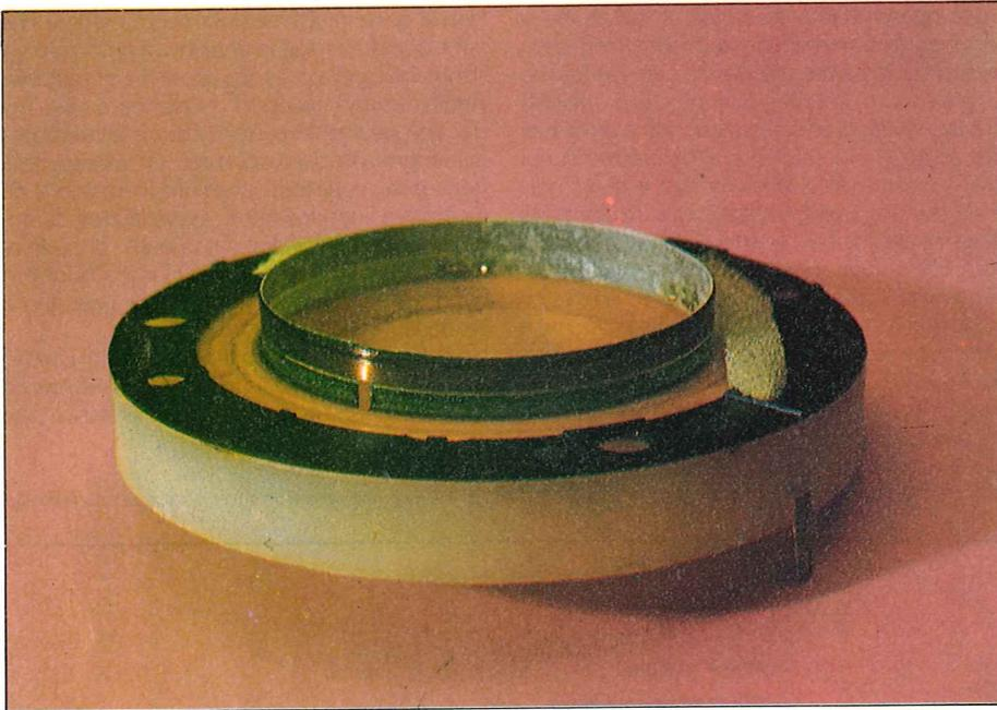
Notevoli i diametri delle bobine mobili, per poter dissipare potenze elevate. I supporti delle bobine sono normalmente rigidi e sottili e molto resistenti al calore, mentre l'avvolgimento è generalmente realizzato in alluminio.
